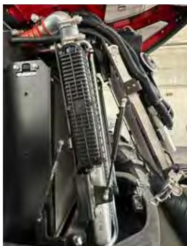
Päť samostatných chladičov pre chladiacu kvapalinu, medzichladič, klimatizáciu, olej a naftu poskytuje lepsie chladenie, tichšiu a pohodnejšiu prevádzku. Zároveň znižuje hromadenie nečistôt v chladičoch a vzduchovom filtri.
